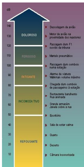
Figura 1 - Escala de valores de nível de pressão sonora (entre 0 dB - limiar da audição - e 130 dB - limiar da dor)
